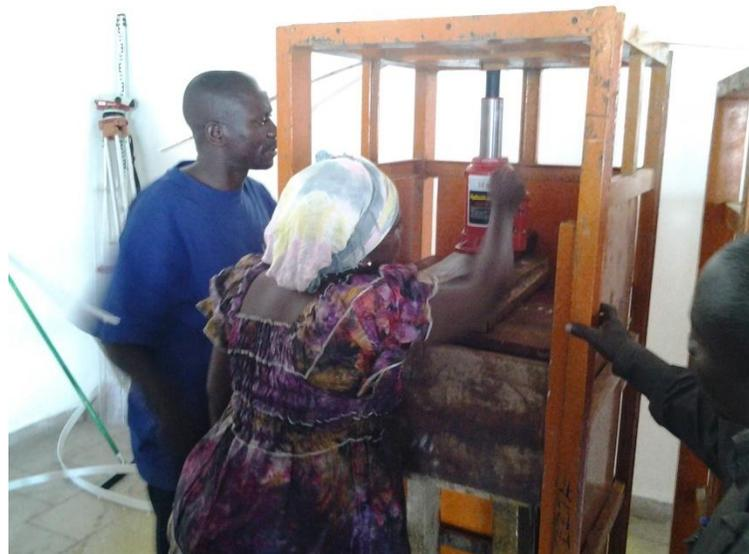
*Photo 17. Presse à crique hydraulique*
