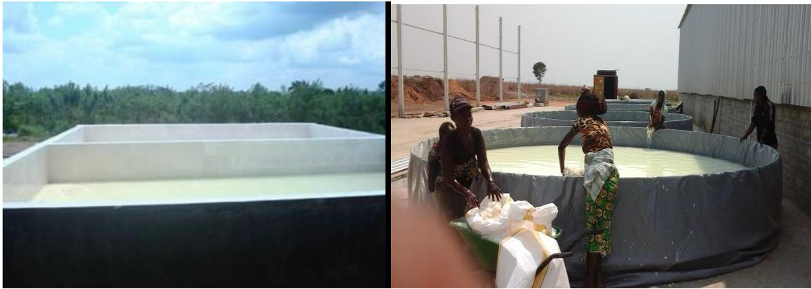
*Photos 11 et 12. Bacs de rouissage de manioc remplis des micro-cossettes*
