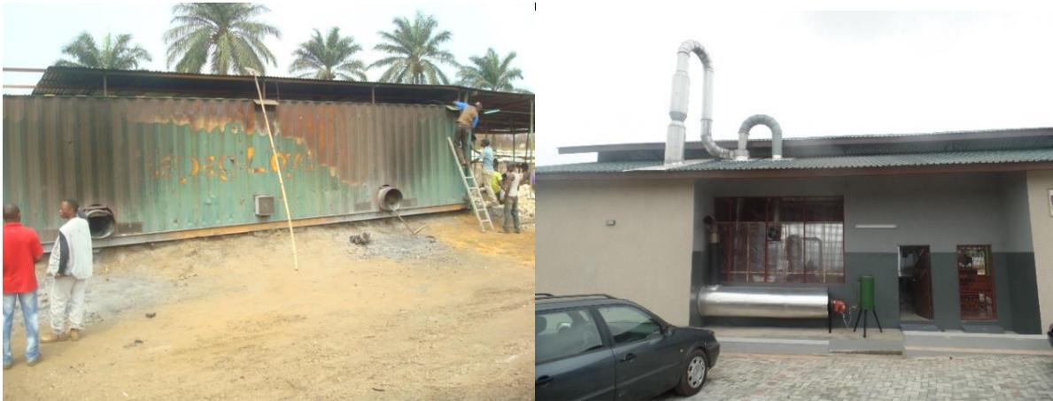
*Photos 18 et 19. Séchoir cabinet (Plateau bateke) et un flash dryer (IITA/Ibadan)*
