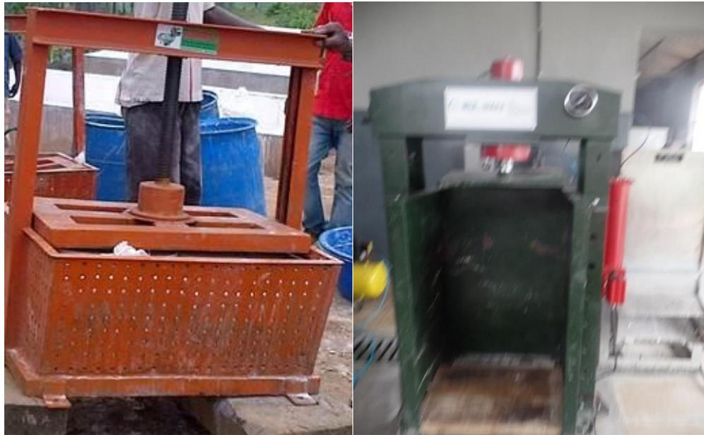
*Photos 13 et 14. Presse à vis sans fin et presse hydraulique*
