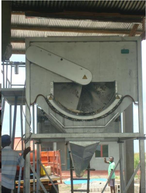
*Photos 6 et 7. Eplucheurs de manioc, utilisés dans unités de transformation de manioc*
